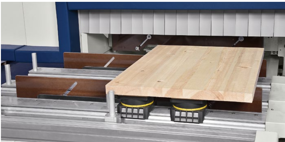
Listwy umieszczone przy belkach bardzo ułatwiają pozycjonowanie ciężkich elementów.
