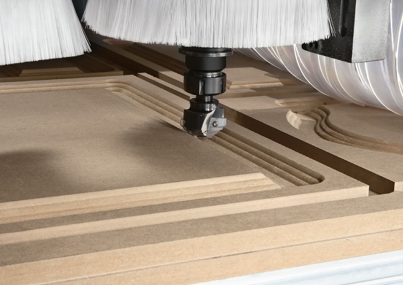
Precyzja obróbki elektrowrzecionem 3 osiowym z prędkością 24.000 obr/min.
