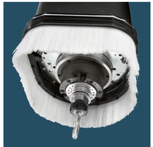
Większa wydajność i oszczędność czasu jest możliwa przy zastosowaniu dodatkowego elektrowrzeciona o mocy 4. kW
